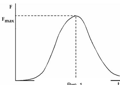
Сила удара  $F$  – это максимальное значение силы  $F_{max}$  в ударном импульсе – представляет собой наибольший «вес» удара, действующий на противника в момент удара в точке приложения ударной конечности. Характеризует эффективность удара.
